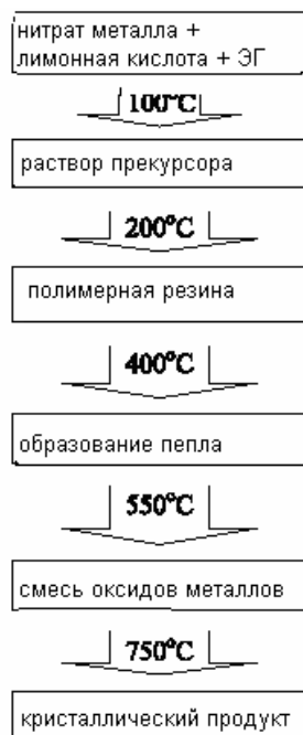
Рис. 13. Схема синтеза нанокристаллического продукта методом пиролиза полимера.
